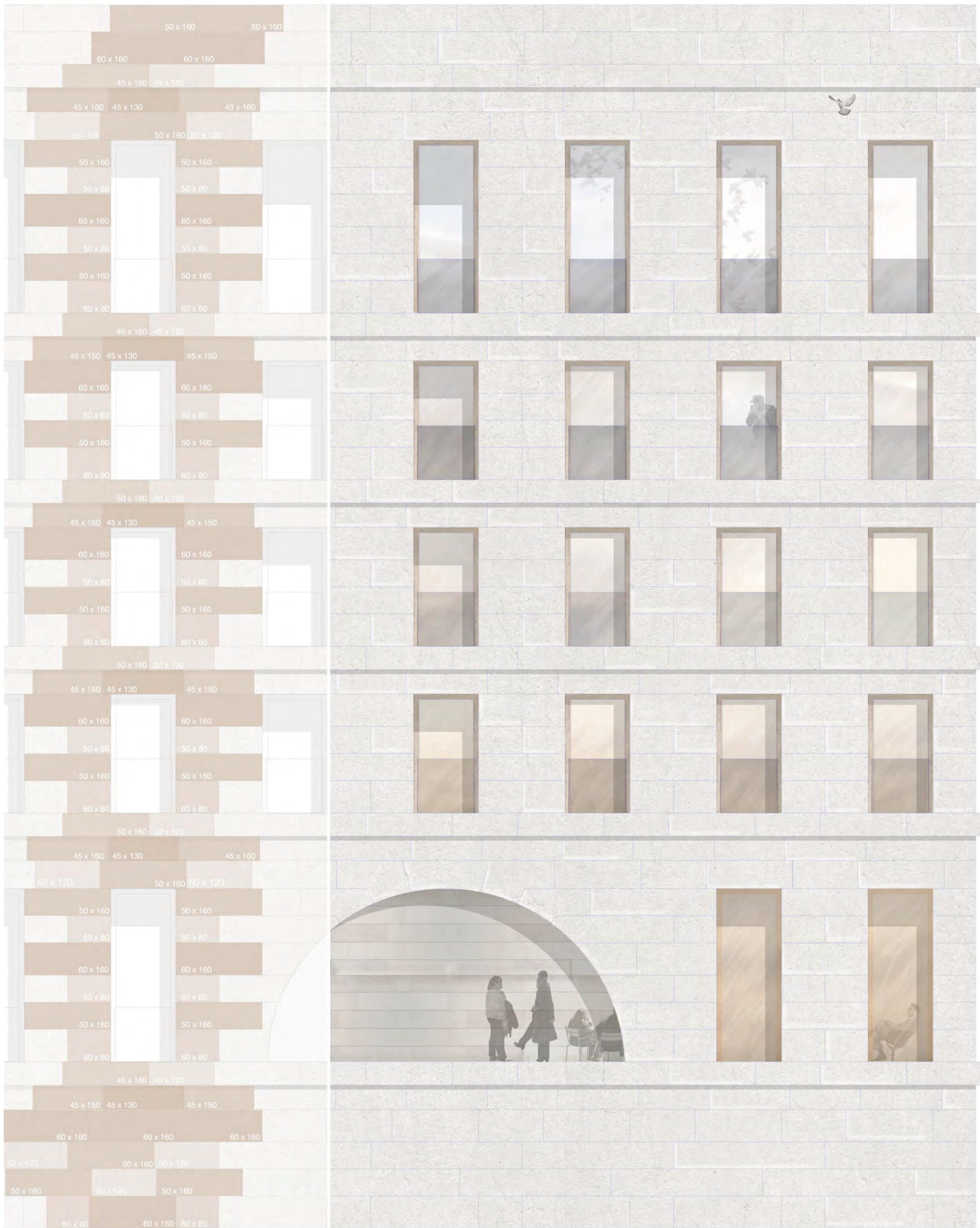
FAÇADE NORD DU PLOT PERMETTANT LA MISE À NIVEAU POUR LE PASSAGE PUBLIC UN CALEPINAGE RATIONNEL DE LA PIERRE AVEC SEULEMENT 8 TAILLES NÉCESSAIRES
